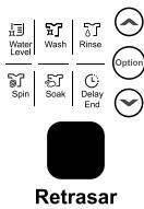
Por último, puede retrasar la hora de inicio para el lavado si lo desea. Presione el botón **Option** (Opción) para seleccionar **Delay End** (Fin del retraso). La pantalla cambiará de minutos a horas. Cada vez que se presione el botón , se agregará 1 hora a la pantalla hasta 24 horas. Una vez más, se cancelará la función Delay (Retraso). La pantalla mostrará 0 horas. A continuación, la pantalla mostrará la hora del programa.
